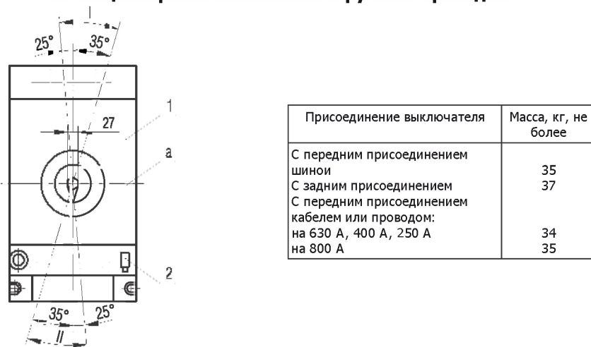
Рисунок А.1 - Выключатели типов ВА52-41, ВА53-41, ВА55-41, ВА56-41 стационарного исполнения с ручным приводом
