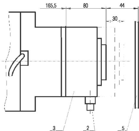
2. Исполнение с электромагнитным приводом.
