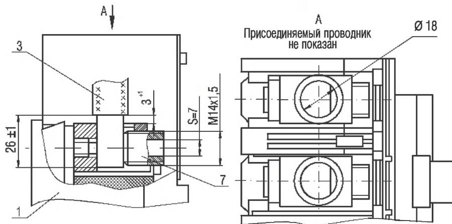
1 - выключатель; 3 - присоединяемый проводник;
