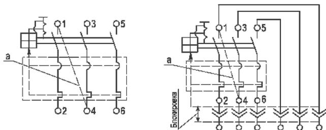
а- перемычка устанавливаемая потребителем на выключателях типа ВА06-36 при напряжении 440 В постоянного тока
