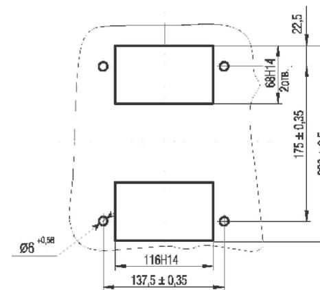
3. Отверстия в распределительном устройстве для установки выключателей.
