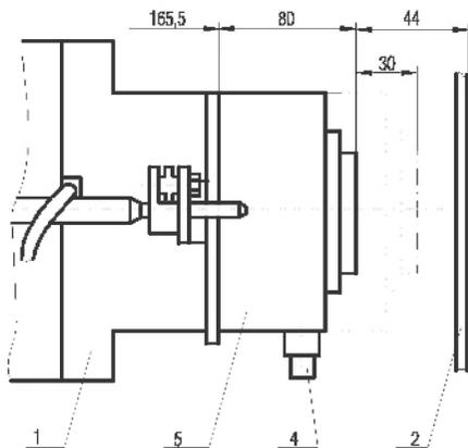
2. Исполнение с электромагнитным приводом. Остальное - см. исполнение 1.
