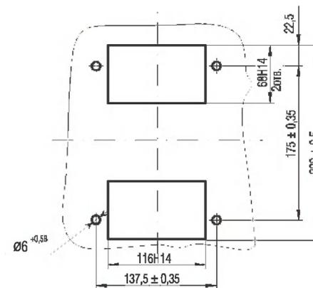
3. Отверстия в распределительном устройстве для установки выключателя.
