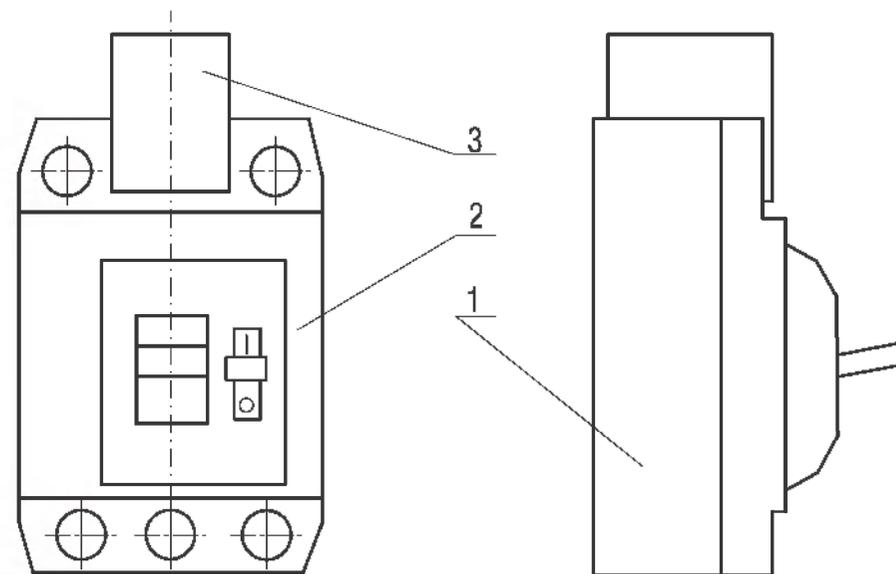
1 - основание выключателя; 2 - крышка выключателя;
