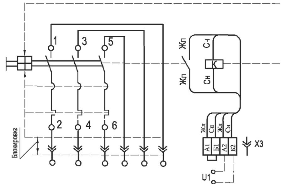
**Рисунок В.8 - Схема электрическая принципиальная выключателя выдвижного и врубного исполнения с независимым расцепителем**
