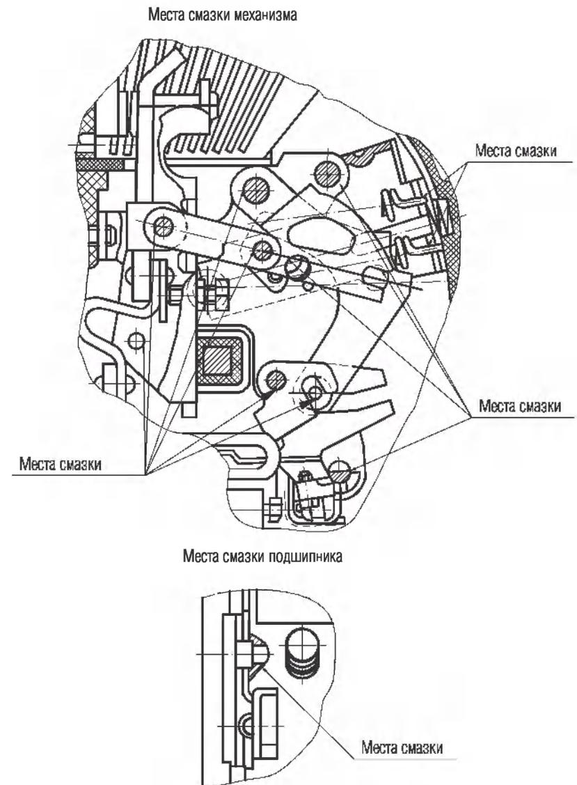
**Рисунок А.12 - Места смазки выключателя.**
