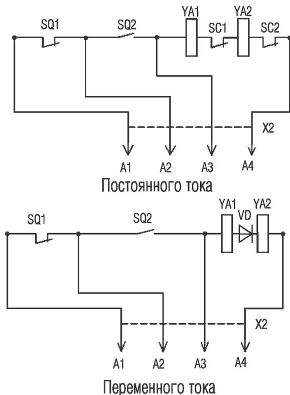
**Рисунок В.6 - Схема электрическая принципиальная электромагнитного привода YA.**
