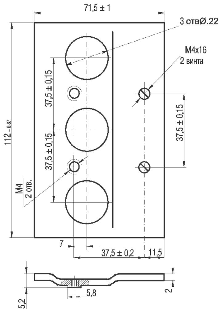
Рисунок А.16 - Скоба для крепления выключателя на рейках с закрытым пазом.
