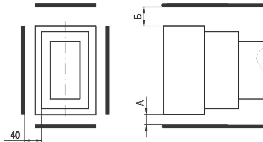
Выключатель выдвижного и втычного (врубного) исполнения
